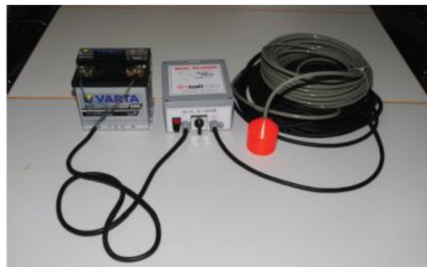
Un « seal scarer », un des deux appareils qui seront déployés pour effaroucher les mammifères marins hors de la zone de danger (source Lofitech)
